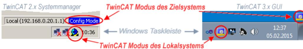
Abb. 107: Unterscheidung Lokalsystem/ Zielsystem (links: TwinCAT 2; rechts: TwinCAT 3)
