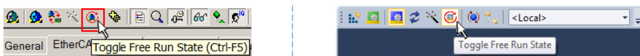
附图 119: TwinCAT也可以通过一个按钮切换到这种状态 (左: TwinCAT 2; 右: TwinCAT 3)
