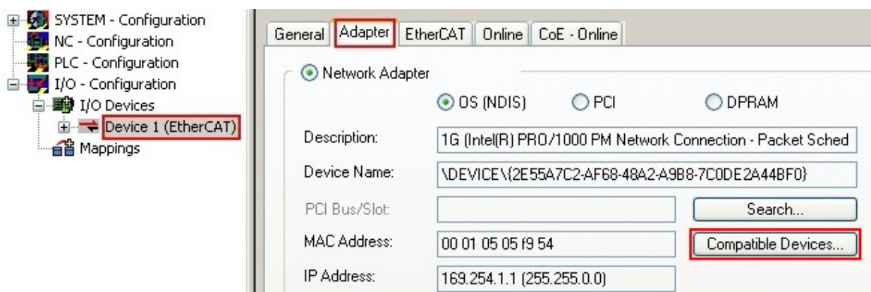
附图 84: EtherCAT设备属性（TwinCAT 2）：点击“适配器”选项卡的“兼容设备...”
