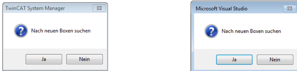
Abb. 97: Scan-Abfrage nach dem automatischen Anlegen eines EtherCAT Gerätes (links: TwinCAT 2; rechts TwinCAT 3)
