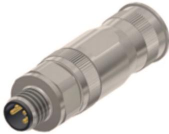
Abb. 26: M8-Stecker, 4-polig, IP67, feldkonfektionierbar
