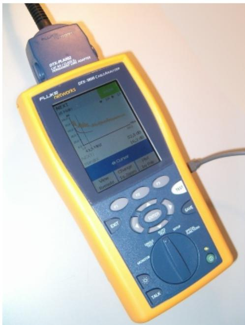
Abb. 3: Kabelzertifizierer, beispielhafte Darstellung
