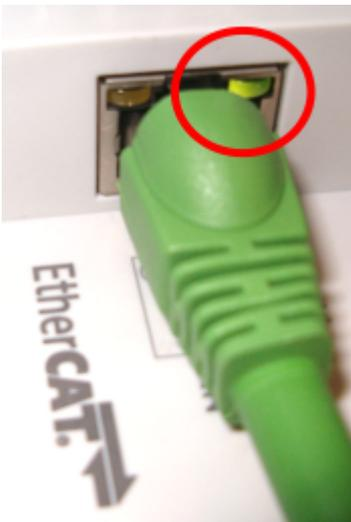
Abb. 33: Link-LED an Ethernet-Geräten
