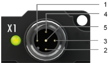
IO-Link-Anschluss, Device (schmales Gehäuse)
