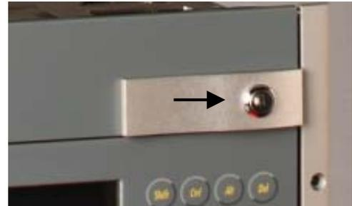
Nach dem Aufschließen der Frontklappe lässt sich diese nach oben klappen.
