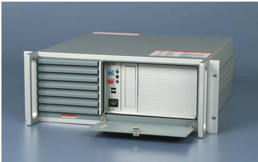
Öffnen der Frontklappe
