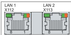
Abb. 6: Ethernet-Schnittstelle Pin-Nummerierung
