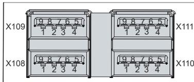
Abb. 5: USB-Schnittstelle Pin-Nummerierung
