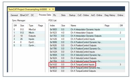
▶ "0x1A32 ChA Torque Control Inputs" auswählen
